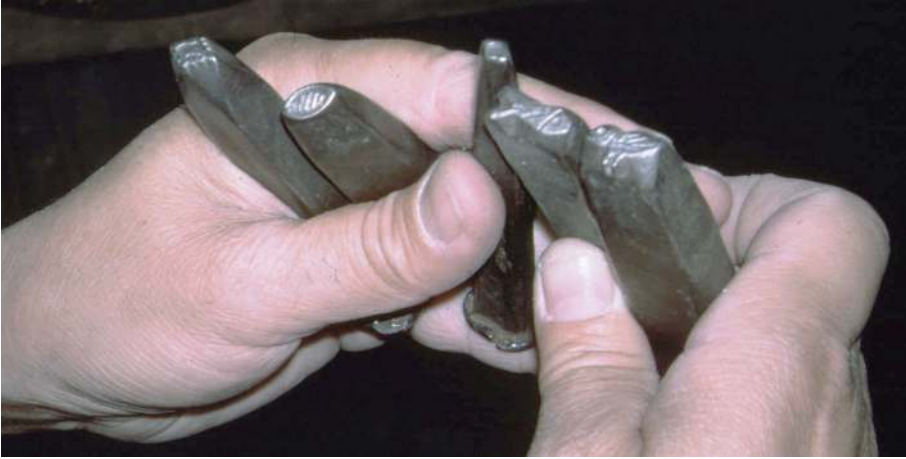
Abb. 9 Photo der komplexen Punzen, die zum Teil ganze Motive darstellen.
