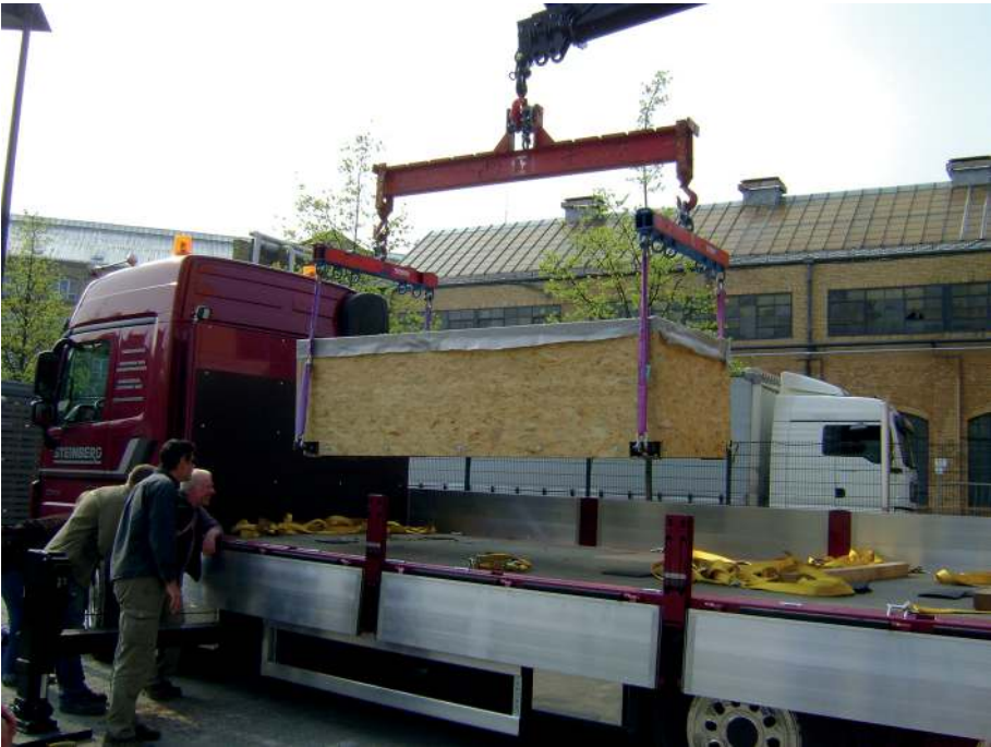
Abb. 3 Entladen der Blockbergung des Burgsdorff-Sarkophags an der Hochschule für Technik und Wirtschaft.
