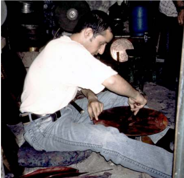
Abb. 2 Nutzung eines Zirkels am Anfang des Punzierungsvorgangs.
