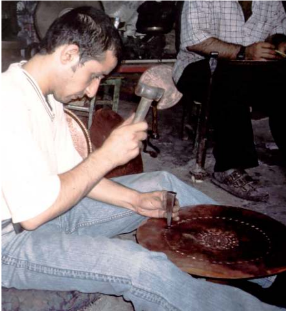
Abb. 6 Punzierung klammerförmiger Motive am äußeren Verzierungrand der Platte; das Vorbild für die zu verzierende Platte ist teils hinter dem linken Arm des Handwerkers sichtbar.
